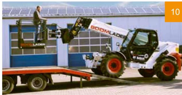
Mit dem **MEIS BOOMLADER®** haben wir den weltweit einzigen Teleskoplader entwickelt, der aus dem Arbeitskorb heraus komplett verfahrbar ist, inklusive aller Abstütz- und Nivellierungsprozesse.
